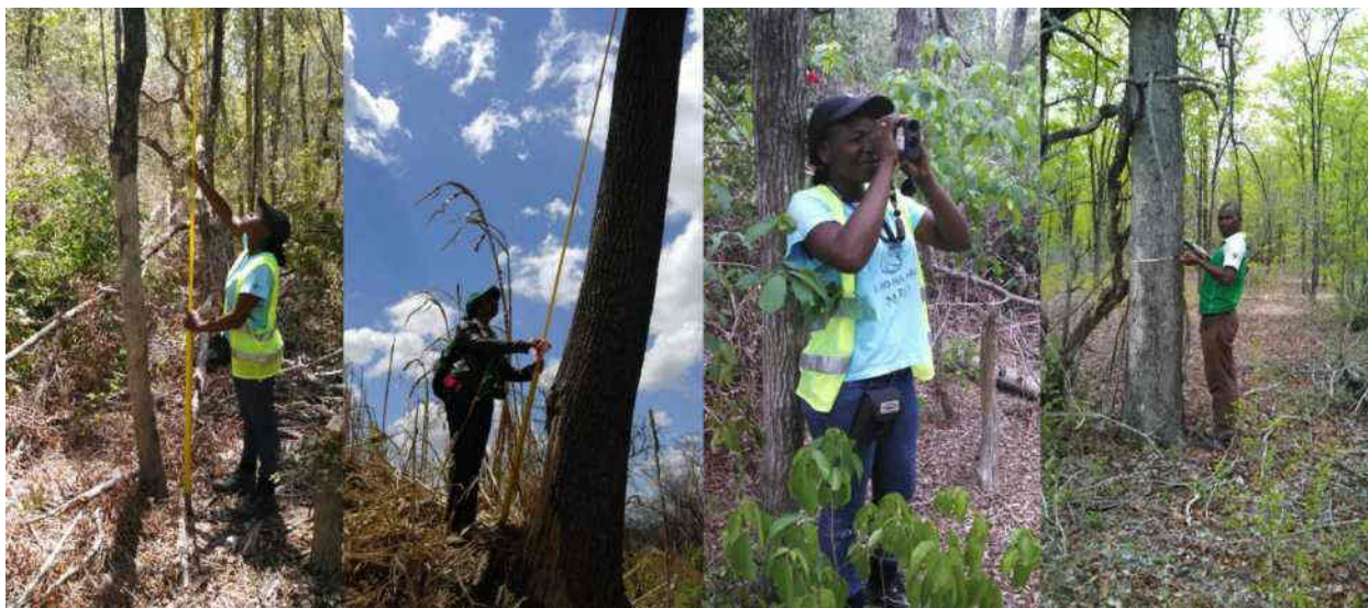
Figura 5: Treinamento dos Técnicos na Medição de Altura usando a barra altimétrica, TruePulse e Medição de DAP usando a fita diamétrica.
