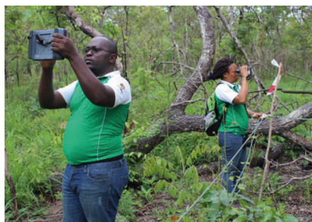
Figura 4. Marcação da parcela usando TruPulse e Captura de imagens da parcela usando o Trimble Yuma
