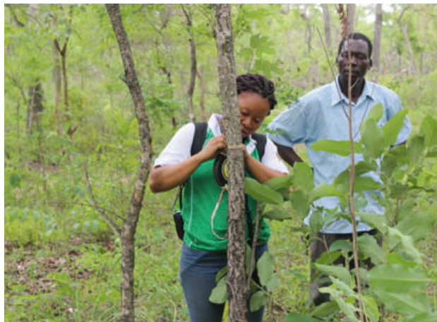
Figura 7. Medição de Diâmetro à Altura do Peito (DAP) usando a fita Diamétrica
