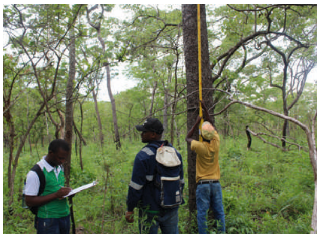
Figura 8. Medição das Alturas Total e Comercial das árvores usando barra altimétrica
